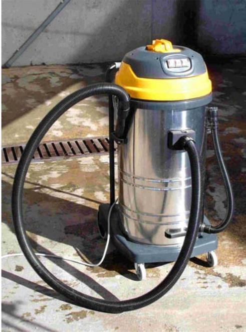
Aspirador de polvo y líquido con depósito en inox, gran capacidad, ligero, filtro de poliéster lavable con posibilidad de poner uno, dos o tres motores de 1.200 W.
