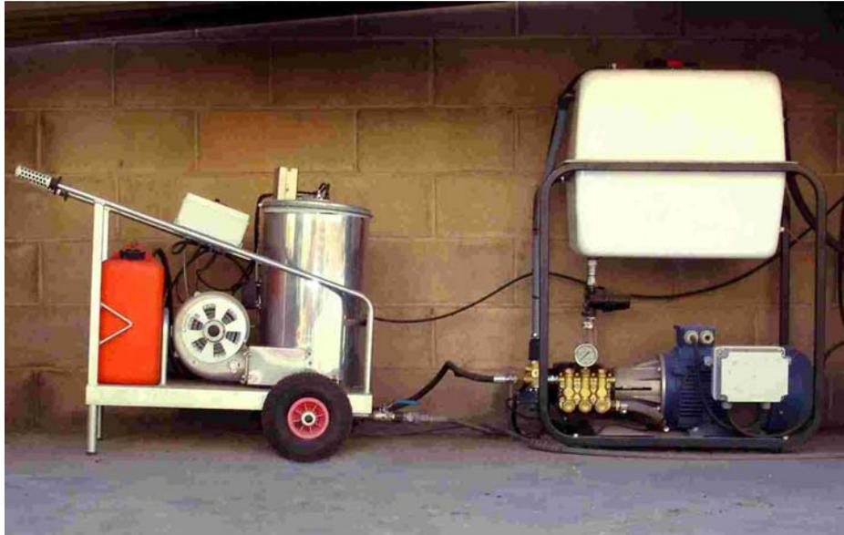
Grupo motor bomba centralizado con caldera de agua caliente independiente. Deposito de poliester 110 Ltros., valvula de detección falta de agua. Stop-total temporizado.
