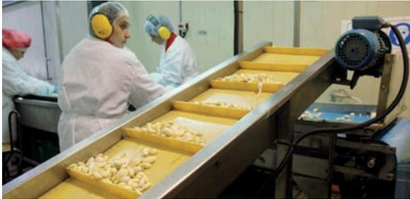
Bandas transportadoras con empujadores, guías, paredes laterales y tacos.
